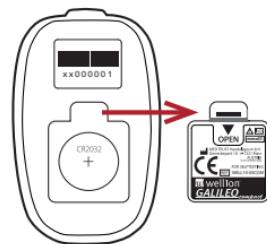
Krok 2: Vložte novou baterii do prostoru baterie tak, aby strana „+“ směřovala nahoru. Pevně zasuňte kryt baterie zpět do glukometru.
