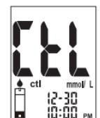
Krok 4: Stiskněte tlačítko ▼ nebo ▲ pro vstup do režimu kontroly. Uprostřed obrazovky uvidíte „ctl“. Ikona „ctl“ se také používá k označení výsledku testu kontrolním roztokem v paměti glukometru.
