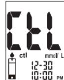
Krok 6: Držte glukometr a dotkněte se kapky kontrolního roztoku koncem testovacího proužku určeného pro vzorek a kontrolní roztok se automaticky natáhne do reakční oblasti testovacího proužku.
