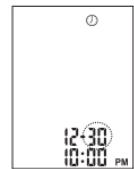
Krok 7 - Nastavení formátu času (12h/24h): Časový formát bude blikat. Použijte tlačítka ▼ nebo ▲ pro volbu formátu času. Stisknutím tlačítka OK potvrďte výběr a pokračujte v nastavování hodin.
