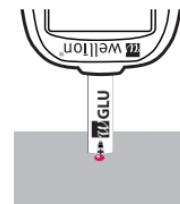
Krok 7: Obrazovka začne odpočítávat. Po 5-ti sekundách se na displeji přístroje zobrazí výsledek testu kontrolním roztokem.
